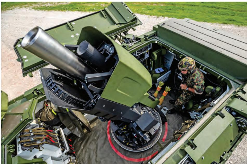
Nel marzo del 2020, sulla piazza d'armi di Bière si sono svolte prove presso la truppa con il mortaio da 12 cm 16. Le capacità tattiche del sistema sono state sottoposte a test da parte della truppa. I difetti di sicurezza constatati durante i collaudi tecnici e che l'anno scorso non avevano permesso alla truppa di effettuare tiri, sono stati eliminati a livello industriale ed è stato possibile
